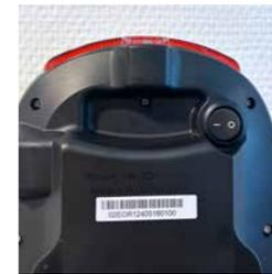
4. Il y a aussi un bouton allumer/éteindre sous la batterie, si vous éteignez cet interrupteur, la batterie ne fonctionnera pas dans le vélo.
